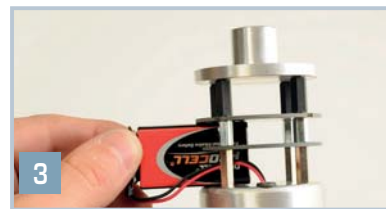
Cambio de la batería.
